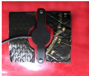
Рисунок 2 – Установка сенсора на поверхность баллона
