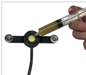
Рисунок 1 – Нанесение смазки на сенсор
