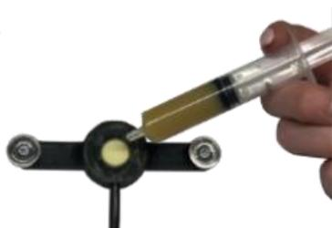
Рисунок 6 - Нанесение смазочной пасты на сенсор
