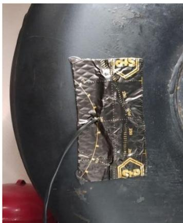
Рисунок 10 - Сенсор, покрытый виброизолом
