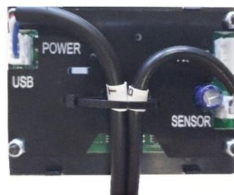
Рисунок 4 - Фиксация проводов на плате контроллера
